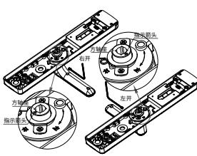
1. 根据门的方向调整把手的方向, 并用六角扳手拧紧螺丝, 锁死把手。
