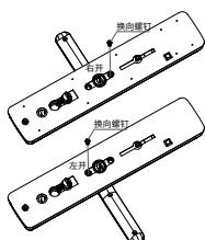
根据门的方向调整把手方向, 然后在相应位置打入换向螺钉。
